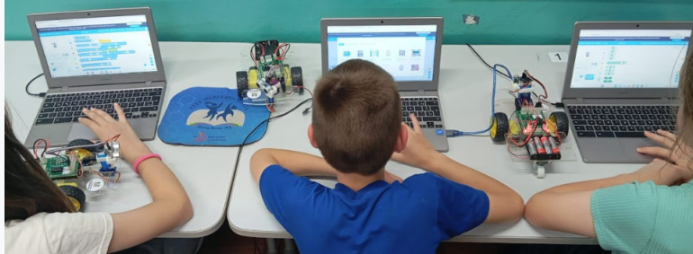
Figura 2 - Processo de programação no mBlock e envio do algoritmo à placa Maker UNO para execução.
